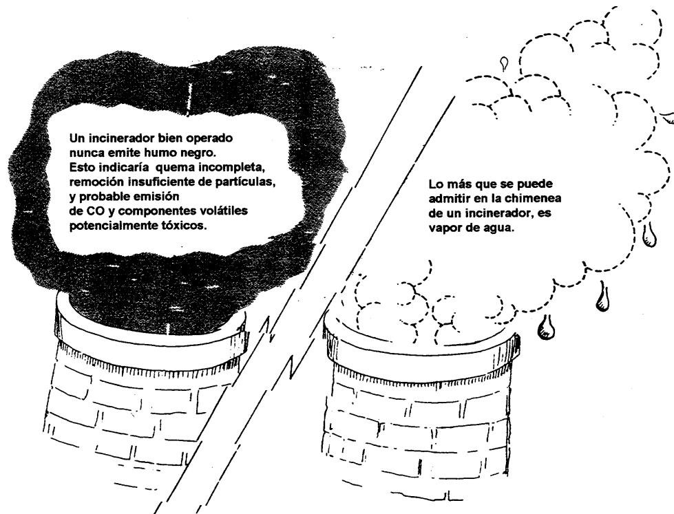
FIGURA 2 Chimenea de un incinerador mal operado / bien operado
