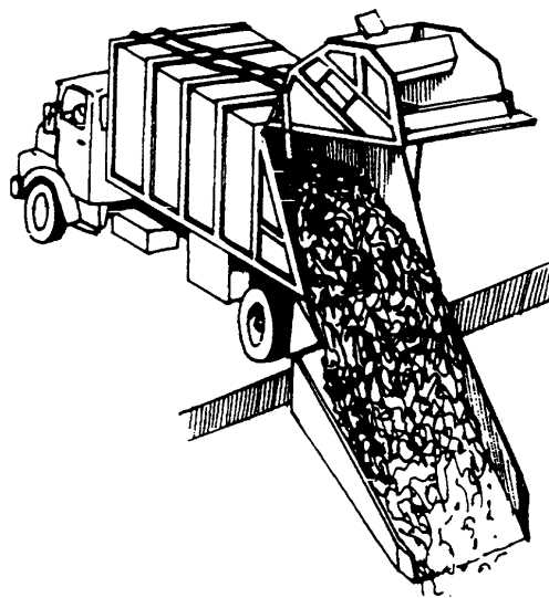
Descarga en tolva o deslizador
