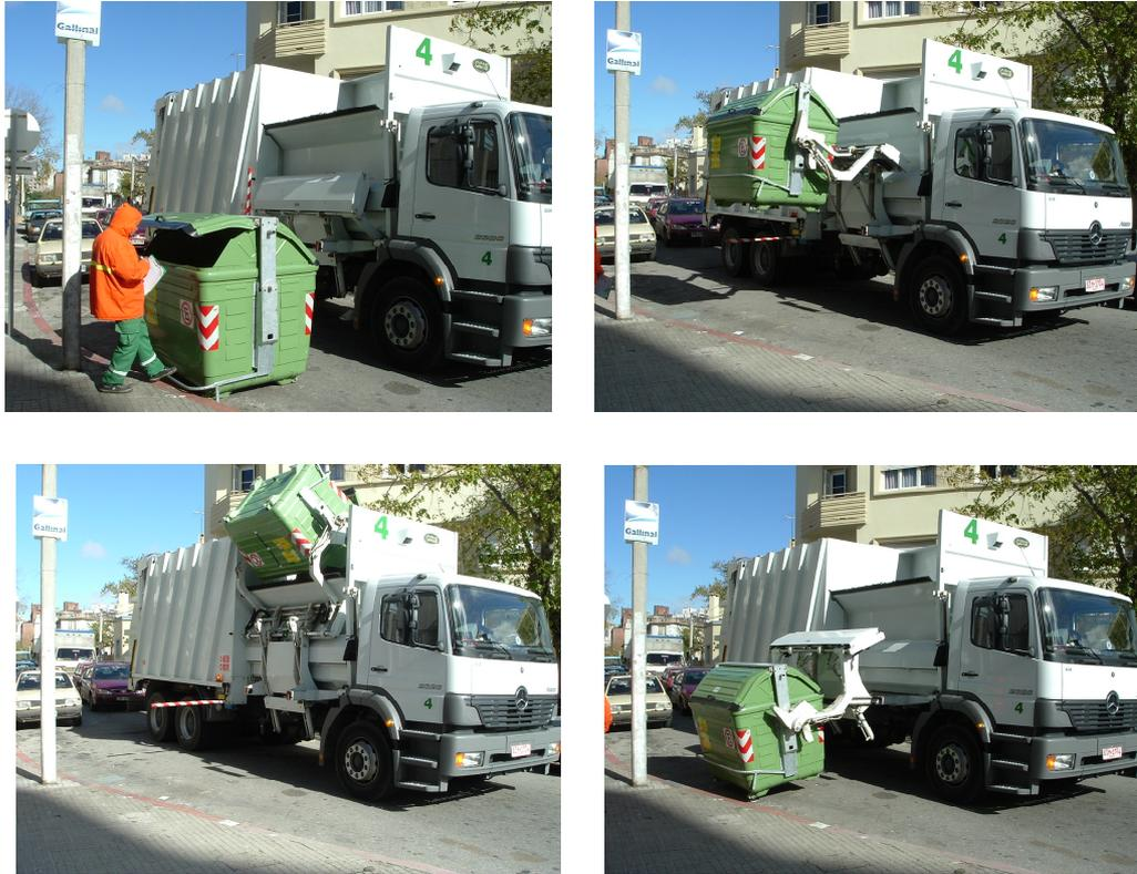
Este sistema lleva consigo una disminución en los recursos humanos necesarios para la ejecución de la tarea, al contar con un mayor grado de mecanización. Para la recolección se utilizan un chofer que conduce y acciona el mecanismo de izaje de los contenedores y un peón que asiste en la maniobra y verifica que no se encuentren dentro de los contenedores elementos incompatibles con el sistema (residuos densos como escombros, elementos de gran tamaño, etc.).
